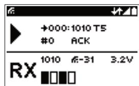
La moitié inférieure donne des informations sur la confirmation avec l'affichage des états de sortie du récepteur avec la puissance d'émission déterminée et la tension d'alimentation du récepteur renvoyée (en fonction du circuit du récepteur). En dessous, une suite de rectangles indique de nouveau les états de sortie confirmés du récepteur.
