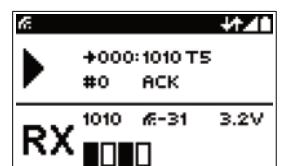
Die untere Hälfte gibt Informationen zur Bestätigung. Es werden die bestätigten Empfänger-Ausgangszustände, die ermittelte Sendeleistung und die zurückgemeldete Empfängerversorgungsspannung (abhängig von Empfängerbeschaltung) angezeigt. Darunter werden mit großen Rechtecken die bestätigten Ausgangszustände des Empfängers nochmals visuell dargestellt.
