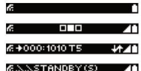
Bei bestimmten gesendeten Daten wird der Zusatz T1, ..., T8 angezeigt. Dieser Zusatz wird bei SVS Produkten häufig als Bezeichnung der Bitkombination angegeben
