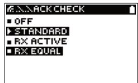
Der aktuell ausgewählte Menüpunkt wird invertiert und mit einem Dreieck dargestellt. Handelt es sich um ein Menü, indem eine Einstellung vorgenommen wird, so wird die aktuelle Einstellung invertiert mit einem Viereck dargestellt. In diesem Fall wird mit der **✓** Taste die aktuelle Auswahl übernommen und in das übergeordnete Menü gewechselt. Mit der Taste **X** wird in das übergeordnete Menü gewechselt ohne die Auswahl zu übernehmen.
