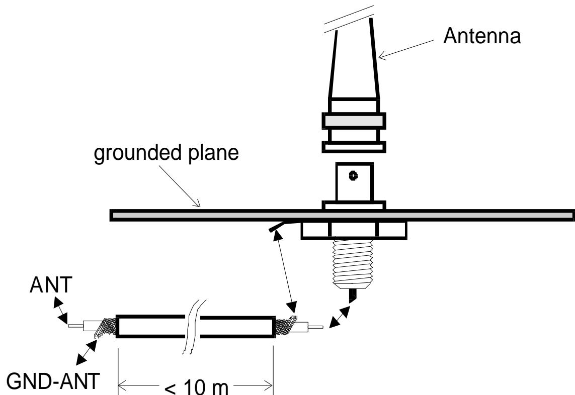
Bild 1: Anschluss eines Antennenkabels
