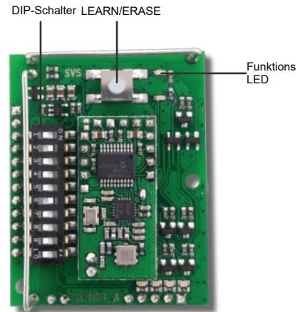
Jeder Lernmodus wird automatisch verlassen, wenn ein Sender oder eine Taste erfolgreich eingelernt wurde, wenn sich der Empfänger länger als 30s in einem Lernmodus befindet oder in einem Lernmodus erneut der LEARN/ERASE Taster betätigt wird. Die LED neben dem Taster leuchtet nur auf, wenn der DIP-Schalter 6 des HF-Empfängers auf „ON“ steht.
